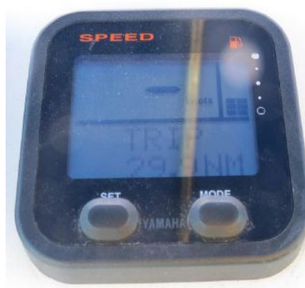
Gambar 2.31 Meter Bot Tidak Berfungsi
